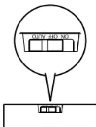
**ON** Když budete chtít svítidlo zapnout tak, aby svítilo nepřetržitě, posuňte vypínač do polohy **ON**.
