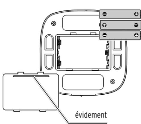
2. Pour enlever le couvercle du compartiment à piles, passez sous l'évidement situé en dessous et soulevez-le.
