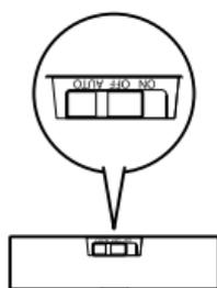
**ON** Pour allumer le luminaire de façon permanente, poussez le bouton sur **ON**.
